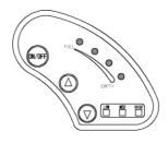
电池电量大于80%,四段LED指示灯全亮。电量下降,指示灯依次熄灭。电量小于20%,最后一个指示灯闪烁(EMPTY端)。当控制器欠压保护,四段LED指示灯全灭,表示当前已处于欠压停机状态。
