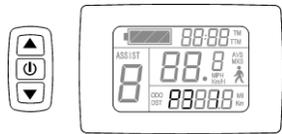
进入P3参数设置界面，P3参数栏闪烁。P3为助力控制模式。P3参数设置为1时，助力控制模式为5档“仿力矩控制”模式。P3
