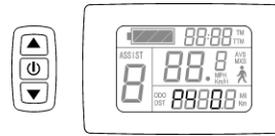
进入P4参数设置界面，P4参数栏闪烁。P4为转把启动模式。P4设置为1时，表示转把为“非零启动”模式，即转把只能在脚踏助力启动后有效。P4设置为0时，表示转把处于“零启动”模式，转把可以直接启动电机。P4的设置范围0或1，短按▲键或▼
