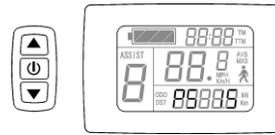
进入P5参数设置界面，P5参数栏闪烁。P5为电量监测模式。P5设置为0时，电量监测为“即时电压”模式。即根据电池的即时电压来判断电池电量方法。当P5等于某一指定参数时，电量监测为“智能电量”模式（该参数根据电池特性确定，普通24V锂电一般在4-11之间，36V锂电在5-15之间）。P5的设置范围在0-40之间，短按▲键或▼键选择。
