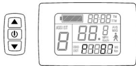
P1 为电机特性参数设置模式。P1 = 电机减速比×转子磁钢片数，如出现小数，则四舍五入。
