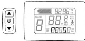
进入P2参数设置界面，P2参数栏闪烁。P2为轮圈转速脉冲信号设置模式。车轮转一圈产生1个脉冲信号，P2应设置为1。车轮转一圈产生6个脉冲信号，P2设置为6。如果用户未配置轮圈脉冲信号系统，可将P2参数设置为0。P2的设置范围在0-6之间，短按▲键或▼键选择。P2参数设置完成，短按⏻键，进入P3参数设置界面。
