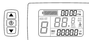
在开机显示界面，短按①键，显示累计骑行时间(TTM)和累计骑行里程(ODO)。再短按①键，返回开机显示界面。在骑行状态下，5秒钟后自动返回开机显示界面。
