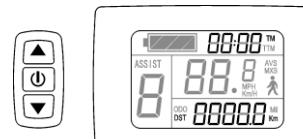
在开机显示界面，显示单次骑行时间(TM)和单次骑行里程(DST)。开机5秒钟后，同时按②和⑤键，单次骑行时间(TM)和单次骑行里程(DST)闪烁。短按①键，二者内容被清除。如果5秒钟内未按①键，则自动返回开机显示界面，原内容被保留。
