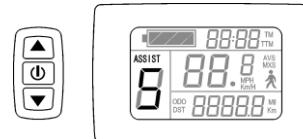
短按③或④键，切换1-5档。1档最低功率档，5档最高功率档。每次开机，自动恢复上次关机时的档位。0档无助力功能。
