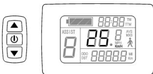
开机后5秒钟内，同时按▲和▼键，最高骑行速度值闪烁。短按▲或▼键，设定最高骑行速度(默认25KM/H)。短按①键，转到下一参数设置。
