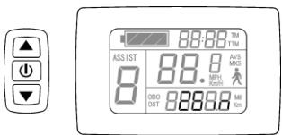
最高骑行速度设置完成，设置轮径， 轮径规格闪烁。短按▲或▼键，设定轮径规格。选择范围8、10、12、14、16、18、20、22、24、26、700c和28英吋。短按①键， 转到下一参数设置。
