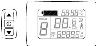
仪表与指定控制器配套使用可实现电池电量的自动识别。电池电量大于70%，四段电量显示全亮，电量下降，电量显示依次熄灭，电量小于15%，四段全灭。当控制器欠压保护，电量显示框闪烁，表示车辆处于欠压停机状态。
