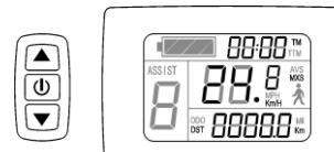
在累计骑行时间和里程显示界面，短按③或④键，显示单次最高骑行速度(MXS)或平均骑行速度(AVS)。再短按①键，返回开机显示界面。在骑行状态下，5秒钟后自动返回开机显示界面。
