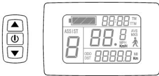
轮径设置完成，设置公英制单位， KM/H和Km或MPH和Mil闪烁。短按▲或▼键，同步选择车速和里程公英制单位。
