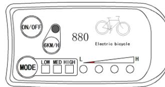
按住6KM/H键，LED功能指示灯闪烁，车辆以不大于6Km/h的速度行驶。释放6KM/H键，功能撤销。
