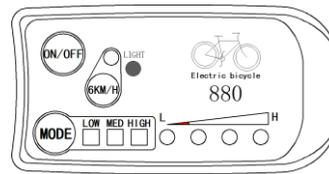
长按MODE键，开启车灯(控制器需有大灯驱动输出或仪表内置大灯驱动输出功能)，LIGHT指示灯亮。再长按MODE键，关闭车灯，LIGHT指示灯灭。
