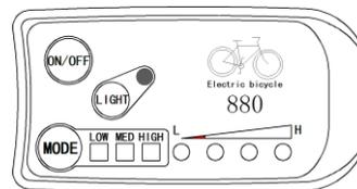
短按LIGHT键，开启车灯(控制器需有大灯驱动输出或仪表内置大灯驱动输出功能)，LIGHT指示灯亮。再短按LIGHT键，关闭车灯，LIGHT指示灯灭。
