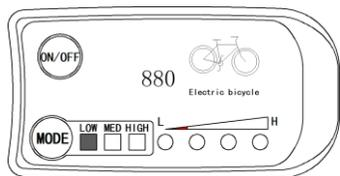
短按 MODE 键，切换 1-3 档。LOW 最低功率档、MED 中间功率档、HIGH 最高功率档。每次开机，自动恢复上次关机时的档位。
