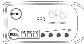
电池电量大于80%，四段LED指示灯全亮。电量下降，指示灯依次熄灭。电量小于20%，最后一个指示灯闪烁（L端）。当控制器欠压保护，四段LED指示灯全灭，表示当前已处于欠压停机状态。
