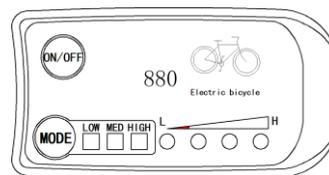
长按MODE键，开启车灯(控制器需有大灯驱动输出或仪表内置大灯驱动输出功能)。再长按MODE键，关闭车灯。
