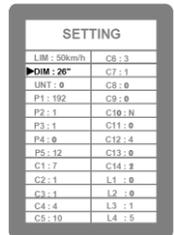
最高骑行速度设置完成,短按 $\text{▼}$ 键设置轮径DIM,短按 $\text{⏻}$ 键轮径DIM闪烁。短按 $\text{▲}$ 或 $\text{▼}$ 键,设定轮径DIM。选择范围5、6、8、10、12、14、16、18、20、22、24、26、700c,28和29英寸。短按 $\text{⏻}$ 键停止闪烁并保存设置。
