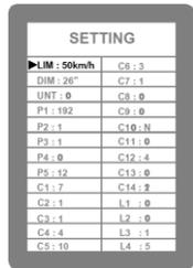
开机后5秒钟内,同时按 $\text{▲}$ 和 $\text{▼}$ 键,短按 $\text{⏻}$ 键,最高骑行速度Km/H和LIM闪烁。短按 $\text{▲}$ 或 $\text{▼}$ 键,设定最高骑行速度值(默认25Km/H)。短按 $\text{⏻}$ 键停止闪烁并保存设置。
