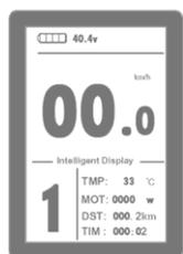
长按 键，开机；再长按 键，关机。当车辆停止行驶且连续 5 分钟未对仪表实施操作，仪表将自动关机并关闭控制器电源。
